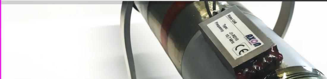
Die leistungsstarke induktive Versorgung der rotierenden Bauteile ermöglicht einen unterbrechungsfreien Einsatz.
