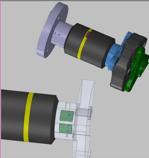
Das J4T-Telemetriesystem ermöglicht die gleichzeitige Übertragung von vier Thermoelement-Signalen von rotierenden Wellen. Die Installation bietet vier Thermoelementbuchsen für eine einfache Zugänglichkeit. Die Sensorverkabelung erfolgt über eine Hohlwelle vom Differentialgetriebe. Eine hocheffiziente induktive Stromversorgung macht es zu einer idealen und zuverlässigen Lösung sowohl für Prüfstände als auch für Fahrzeugtests.
